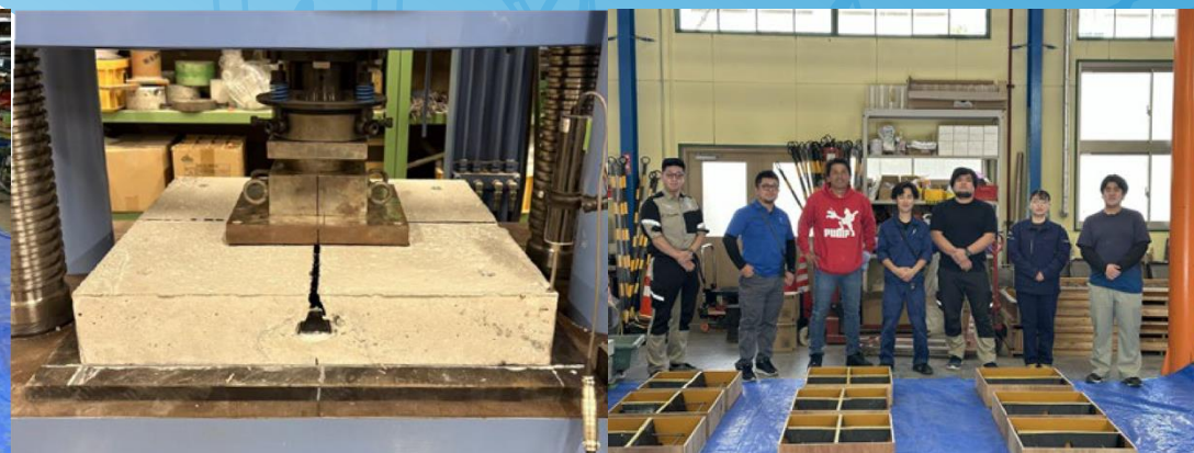
100kN 載荷試験状況
