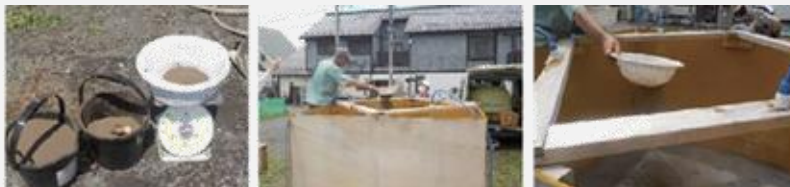
写真2-14 目詰まり物質とその荷重状況 (歩道部ケース1)
