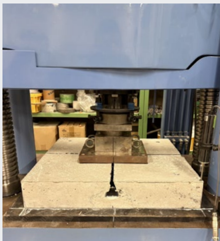
100kN 載荷試験状況
